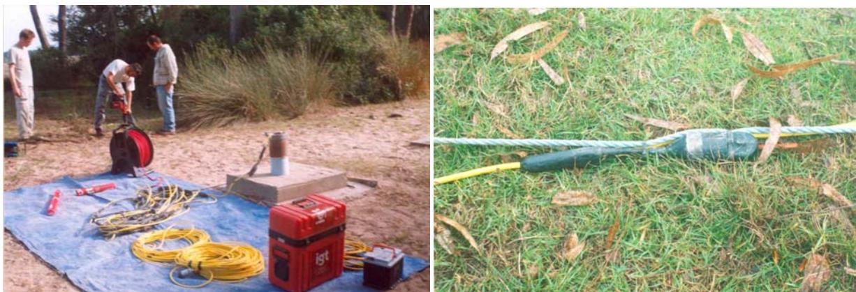
**Fig. 240. Cadena de hidrófonos utilizados para las mediciones de velocidad en sondeos “down hole”**
