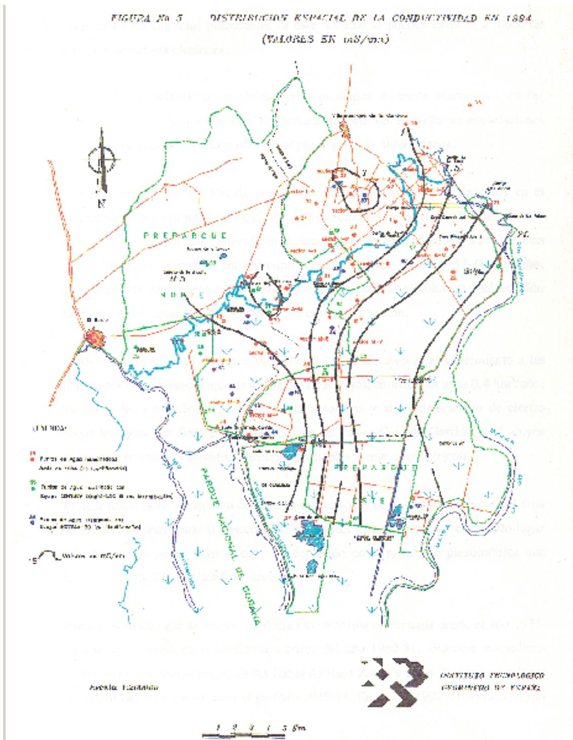
**Fig. 170. Posición de los sondeos testificados e indicación de las líneas de isoconductividad en 1994. [fichero 46Fig-5.tif]**
