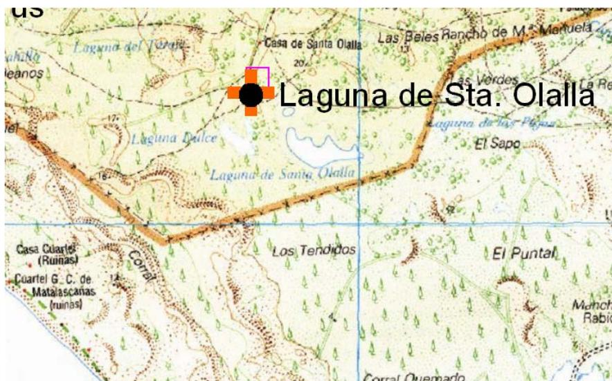
**Fig. 326. Posición del SEV (cruz), SEDT (cuadrado) y sondeo testificado (círculo) en la zona de Santa Olalla.**
